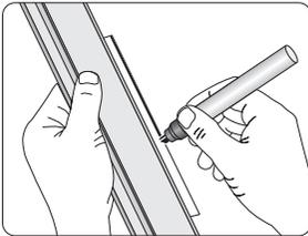
Die Schleiffase mit einem Filzschreiber einfärben, um bei der Winklereinstellung sehen zu können, wo geschliffen wird.
