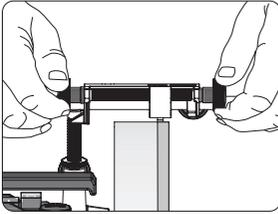
Kontrollieren Sie, dass der Schleifstein beim Drehen genau rund und die Schleiffläche eben ist. Falls notwendig, mit dem Dreh- und Abrichtwerkzeug TT-50 begradigen.
