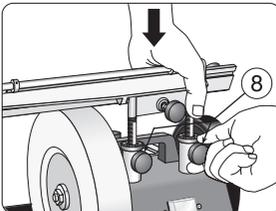
Stützplatte beim Festschrauben nach unten drücken und beide Feststellknöpfe anziehen (8).
