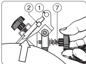
Grobeinstellung der Höhe der Vorrichtung mit Hilfe der zwei Einstellringe (6). Einstellung des Schleifwinkels mit dem Einstellknopf (7). Feineinstellung mittels der beiden Einstellringe (6). Die Schleiffase soll am Stein anliegen und der Messerhalter (2) gleichzeitig auf der Stützplatte (1) ruhen.
