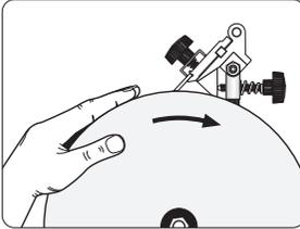
Mit der Hand die Scheibe drehen, um Winkeleinstellung zu kontrollieren. Die Scheibe soll an der gesamten eingefärbten Fläche arbeiten.
