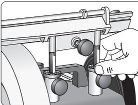
Zum Einstellen der Schleiftiefe die Ringe (6) nach oben schrauben. Beide Ringe gleichweit nach oben drehen, um Paralleleinstellung beizubehalten. Die Schleiftiefe kann an den Ringen abgelesen werden, die einen Grad pro 0,1 mm haben.
