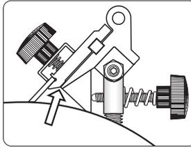
Wenn der Messerhalter an der Stützplatte anliegt, ist der Schleifvorgang beendet. Alle Hobelmesser eines Satzes mit der gleichen Einstellung schleifen.
