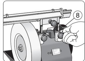
Die Feststellknöpfe (8) lösen und die Stützplatte auf die eingestellte Schleiftiefe absenken.
